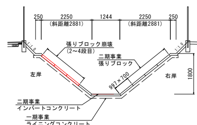
図-1 用水路断面図 Aqueduct cross section
